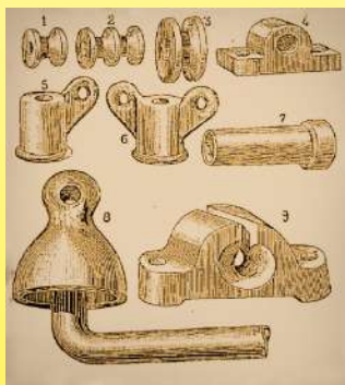
1885 Isolateurs électriques en porcelaine (La physique moderne : l'électricité dans la maison, É. Hospitalier)
