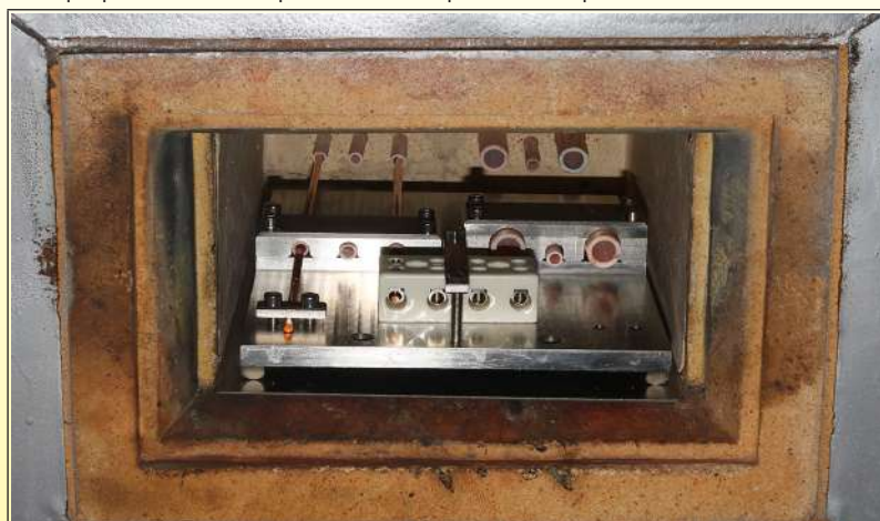
Four d'essai de la résistivité des céramiques en fonction de la température (Laboratoire Ultimheat)
